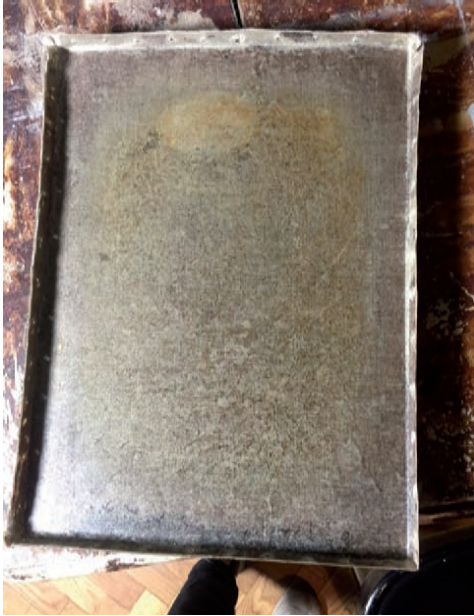
Fig. c - Zona coperta da colla animale, causa della craquelure
